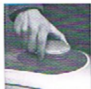
Tank mit altem Deckel verschließen. Oder: Plastikfolie zwischen Deckel und Einfüllöffnung legen.
